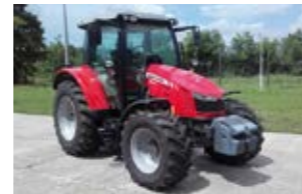
5611 D4 • EuroLine • 110 LE • 20 üő. • 3 pár hidraulika szelep, mellsőhid rugózás • 64,250 EUR
