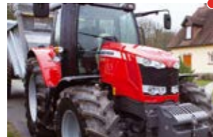
6613 D6 • Essential6 • 130 LE • 50 km-es váltó, 4.8 l-es motor, fülkerugózás • 72,000 EUR
