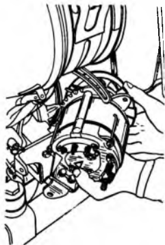
8. ábra A generátor levétele
