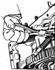
268. ábra A differenciálzár-villa vonórudjának kibintosítása
