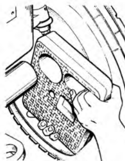
165. ábra A pótsúlyok levétele
