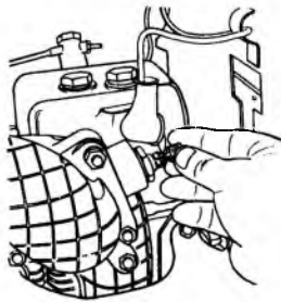
48. ábra A villamosvezeték leszerelése az ízzógyertyáról
