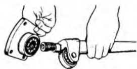
154. ábra Az oldalsó fedél leszerelése
