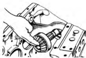
257. ábra A nyelestengely kiszérése a csapággal együtt
