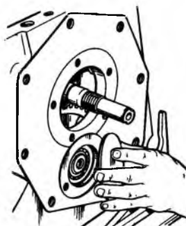
259. ábra A hajtótengely csapágház-fedelének levétele
