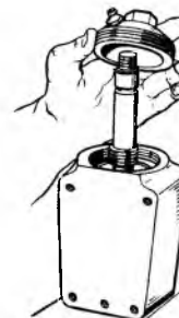
157. ábra A kormányoszlop fedelének kicsavarása
