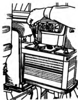
3. ábra Az akkumulátorok áthidalójának leszerelése
