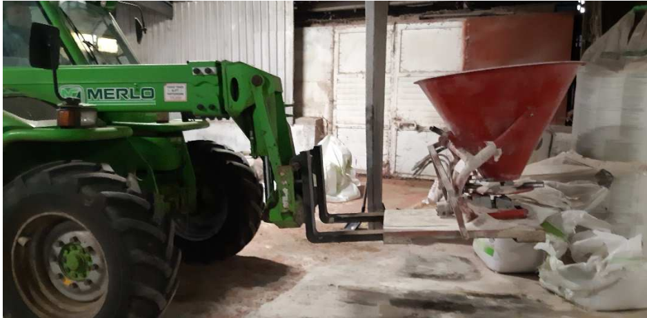
6. kép Átalakított műtrágyaszóró Bactériolit oltására (fénykép: Sztupa Gergely)
