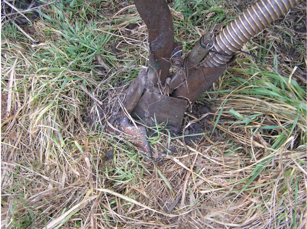
Abb. 3: Gänsefußschar durchschneiden ganzflächig den Boden. Auf den unbearbeiteten,, wasserführenden Horizont wird das Saatgut mittels Bandsaat abgelegt
