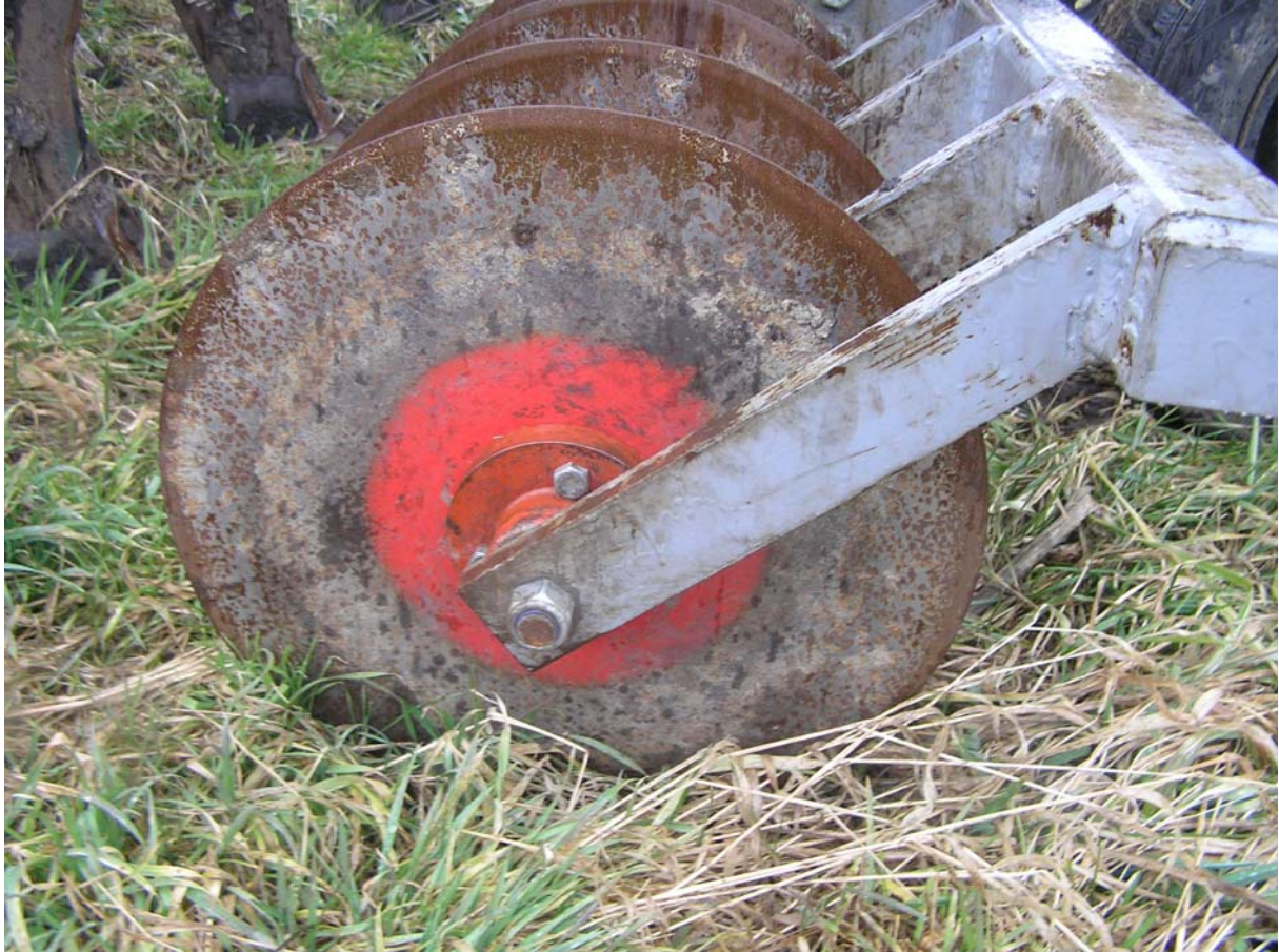
Abb.2: Scheiben durchschneiden vor jedem Schar den Boden und das aufliegende Mulchmaterial
