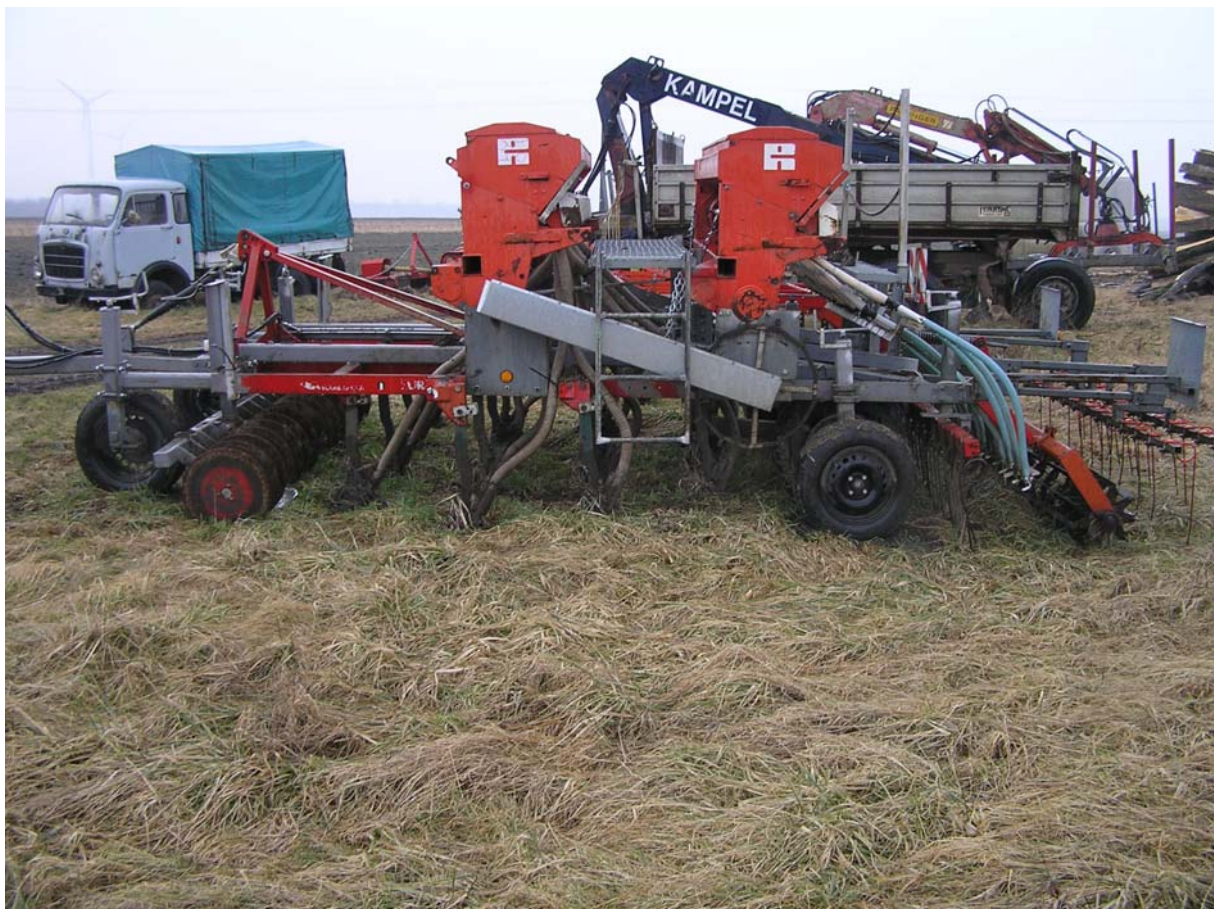
Abb.1. Mulchsaatgerät, Eigenbau Frank: Arbeitswerkzeuge von vorne nach hinten: Schneidscheiben, Gänsefußschare mit Särohren, Striegel, Särohre für Feinsämereien, Walze, Striegel
